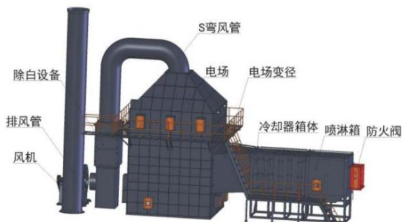
图 6.2-7 “水喷淋+静电净化”设备示意图
